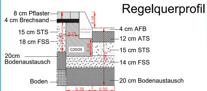
Für den Einbau von Busbordsteinen mindestens 20 cm dickes Fundament mit Rückenstütze aus Beton C20/25 versetzen.
